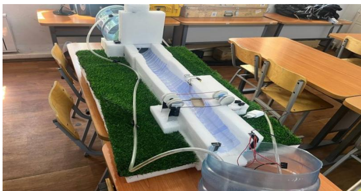
4-rasm. Suv sathi ogohlantirish tizimi va umumiy model ko'rinishi.
